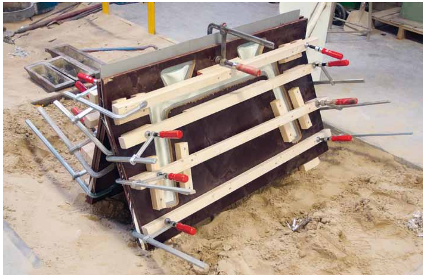
← Processo produttivo (a sinistra) e dettaglio (in basso a destra) di un mobile della collezione Stencil, disegnata da Julien Carretero, 2012. È in fusione di alluminio e tessuto, frutto di tre anni di sperimentazione per contenere i costi di produzione (grazie a stampi riutilizzabili) di questa complessa tecnologia e ridurre gli sprechi di materiale. In basso a sinistra: mobile-seduta Nacelle, disegnato da Julien Carretero in collaborazione con il produttore di imbottiti Kohlmaier Wien, in occasione della Vienna Design Week 2012. • Production process (left) and detail (below right) for a piece of furniture in the Stencil collection, designed by Julien Carretero, 2012. Made of cast aluminium and fabric, it is the fruit of three years' experimentation to cut the production costs (thanks to reusable moulds) of this complex technology and to reduce wastage of materials. Below left: the Nacelle furniture-seat, designed by Julien Carretero in collaboration with the upholstered furniture maker Kohlmaier Wien, for Vienna Design Week 2012
